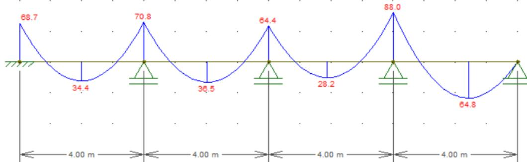
**Figura 27 – Diagrama de momento fletor da viga 3.**
