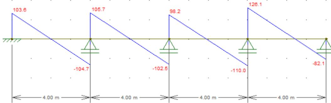
**Figura 26 – Diagrama de esforço cortante da viga 3.**
