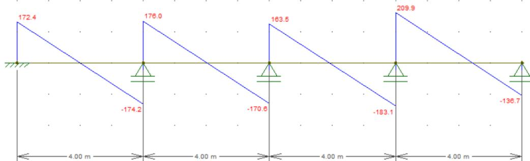
**Figura 32 – Diagrama de esforço cortante da viga 4.**
