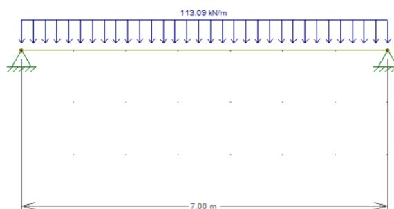
**Figura 42 – Pórtico isostático da viga de aço 2.**
